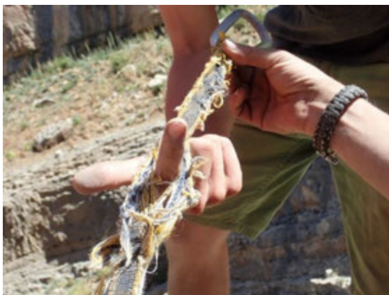
Figure 2: Etat d'une longe neuve à la fin de l'expé (LBH)
