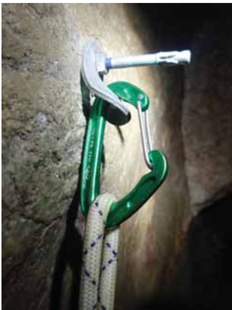
Il est possible de visser un goujon dans un spit en le mettant à l'envers. Photo : Nicolas Aleman
