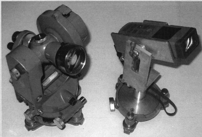
À gauche, un théodolite. À droite: Distobidule monté sur une base de théodolite.
