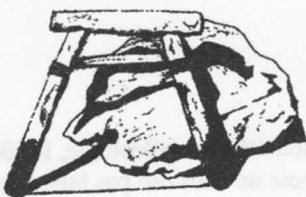
Dessin n°1 : outil pour malaxer et couper l'argile avant son utilisation.
