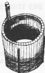
Dessin n°3 : moule en bambou autour duquel est enroulé l'argile. On remarque les 4 baguettes verticales pour le pré-découpage des tuiles. Lors de son utilisation, l'ensemble est recouvert d'une toile de jute.
