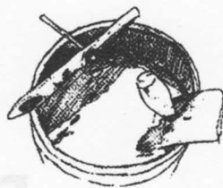
Dessin n°4 : Bac d'eau avec, posés sur le rebord, le lissoir et le gabarit.
