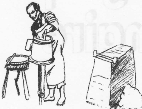
Dessin n°5 : Artisan tuilier lissant la surface des quatre tuiles qu'il vient d'enrouler autour du moule en bambou. À côté de lui se trouve un bac d'eau sur lequel est posé le gabarit (dessin n°4). De l'autre côté, le tas d'argile pyramidal est prêt à être utilisé. L'outil du dessin n°2 est posé dessus.
