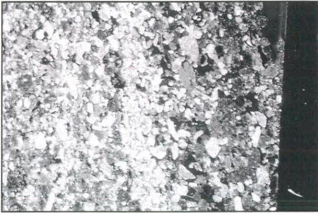
Photo 43 : Alternance de lamines à carbonates (à gauche) et de lamines peu détritiques et sans carbonate (à droite) dans un système de saisons sans mousson d'été (base de la coupe de Dadong). Les carbonates s'expliquent sans doute par cryogénie. Dans tous les cas, les sols sont encore relativement filtrants bien que les conditions soient très froides (on se situe à la fin de la dernière glaciation). Ech. 15/A1, lum. pol. analysée, obj. 2,5 x 3,2. échelle 1cm = 523  $\mu$
