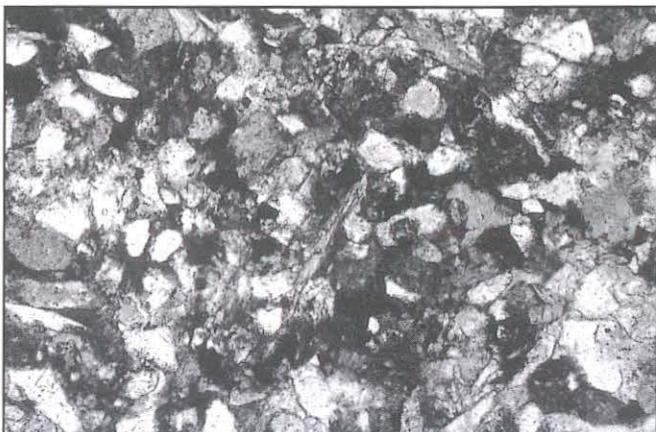
Photo 58 : Quartz détritiques (en blanc) issus de l'altération de phyllades dans la masse de fond des dépôts rouges (ou "rougier") d'un synclinal de la région de Sangzhi. Ech. 6, lum. pol. analysée, obj. 10 x 3,2, échelle 1 cm = 131  $\mu$ m
