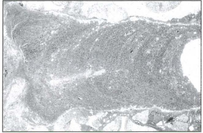
Photo 63 : Autre stade d'altération du calcaire marqué par une première génération de cutanes d'argiles fines (microsidérite), microlitées. Ech. 16/A3, lum. pol. non analysée, obj. 2,5 x 3,2. échelle 1 cm = 523  $\mu$ m
