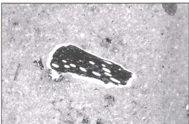
Photo 75 : Les particules charbonneuses s'intensifient et diminuent en taille ; elles sont mélangées aux séquences rythmées de produits d'érosion qui transitent sur les versants. Ech. 41/C3, lame 24 167, lum. pol. non analysée, obj. 2,5 x 3,2. échelle 1 cm = 523  $\mu$
