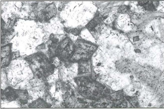
Photo 62 : Altération du calcaire ordovicien par infiltration du fer et des complexes silicatés. Il se produit des néoformations de sidéro-cutanes et de beaux cristaux de sidérite (en sombre) contribuant à la dissociation des assemblages de calcite (en blanc). Ech. 16/A2, lum. pol. non analysée, obj. 10 x 3,2. échelle 1 cm = 131  $\mu$ m
