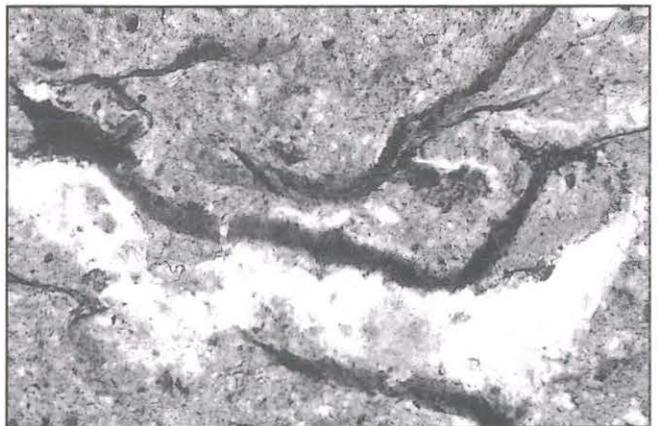
Photo 81 : Détail d'une colonie alguo-bactérienne filamenteuse dans le remplissage holocène vers - 12 m attestant une bonne oxygénation et un probable réchauffement du milieu. Ech. 15/A1, lum. pol. non analysée, obj. 10 x 3,2. échelle 1 cm = 131 µ
