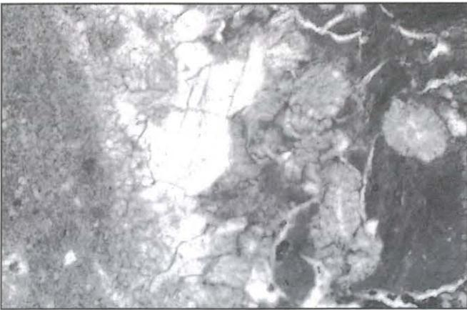
Photo 64 : Enregistrement des épisodes successifs de ciments ayant contribué à l'altération de la roche avec 1) bréchification et formation d'un ciment à sidérite + coiffes microstriées de sidérite (à droite), 2) argilisation et néoformation de fer sulfato-bactérien (au centre), 3) recristallisation de sparite (au centre), 4) néoformation de complexes argileux (à droite). Ech. 15/A1, lum. pol. non analysée, obj. 10 x 3,2. échelle 1 cm = 131  $\mu$ m
