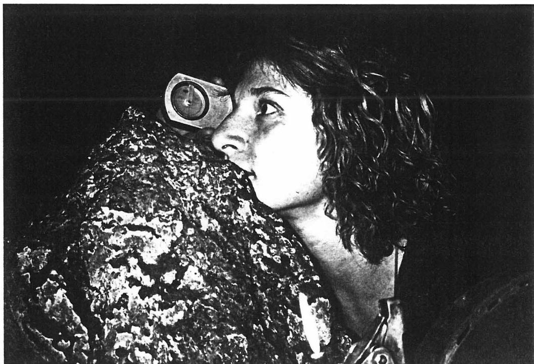
**TOPOGRAPHIE : mesure des pentes à l'aide du clinomètre.**
