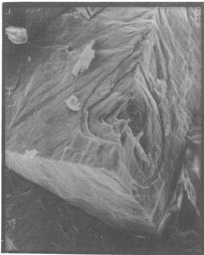
Photo 2 : Photo de coupelle au M.E.B. montrant une belle figure de dissolution sur un rhomboèdre de calcite. (x 350).
