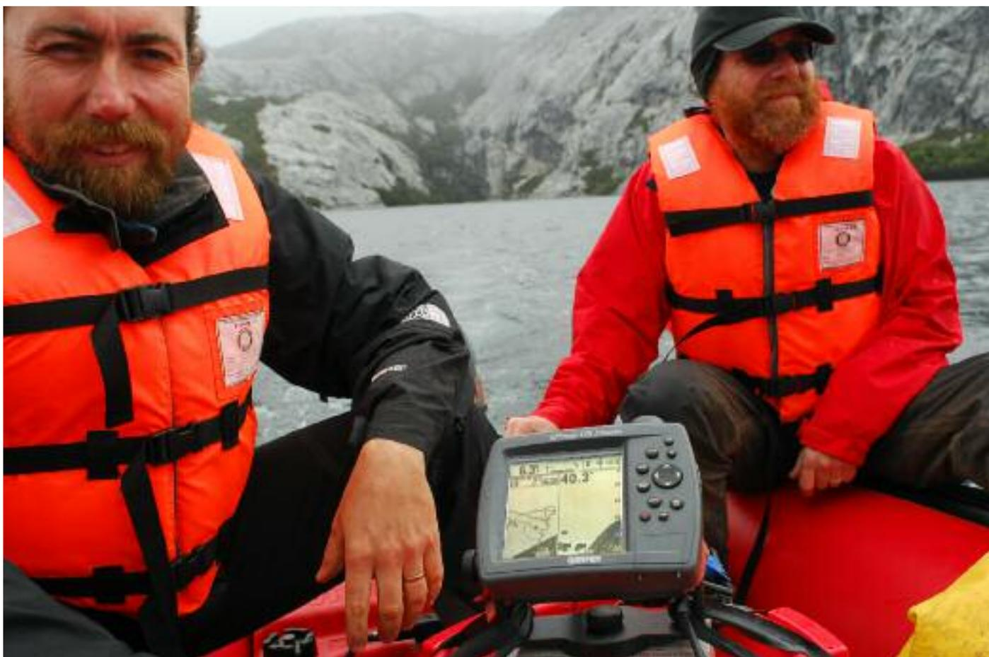
Mise en œuvre du sondeur/GPS Map 178 Garmin sur zodiac. Noter sur l'écran, à droite, la vitesse et la trajectoire enregistrée et à gauche la profondeur.
