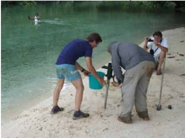
Mise en œuvre de la pompe Bou-Rouch (BL)
