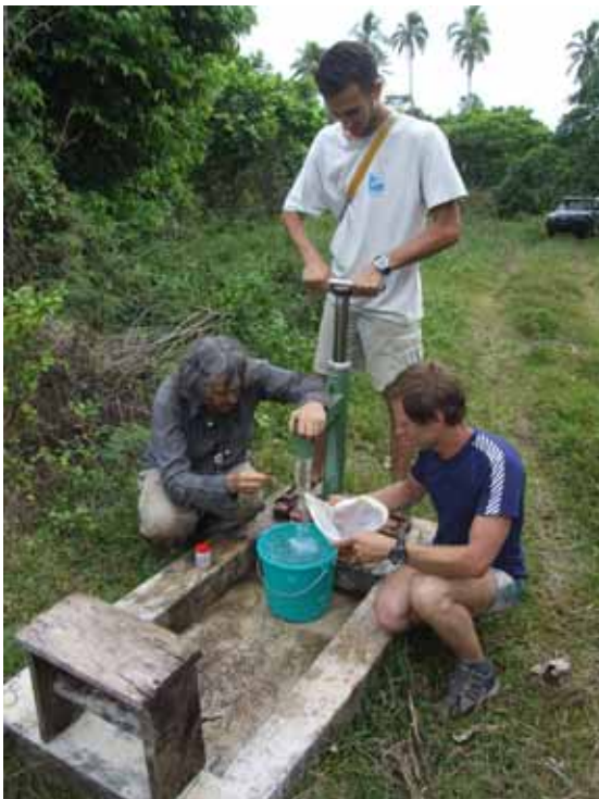
Filtrage à la sortie d'une pompe en place (BL)
